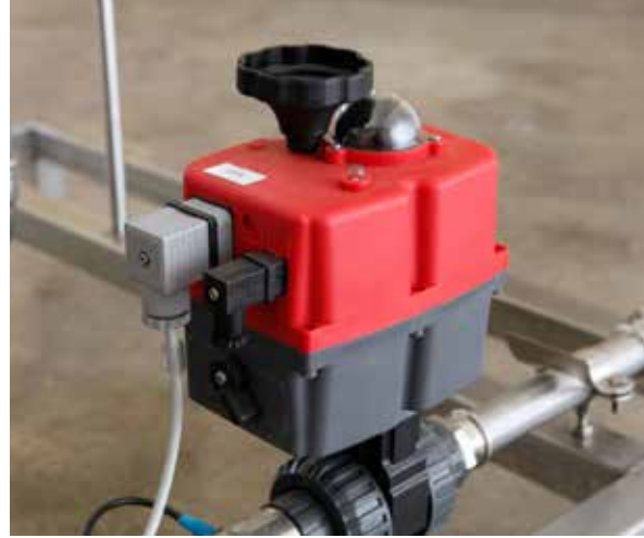
ELECTROVÁLVULA AUTOMÁTICA Permite fazer a gestão do equipamento automaticamente.
