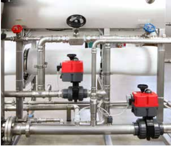
VÁLVULAS DE REGULAGEM MANUAIS Permitem uma gestão pontual da pressão sobre a membrana.
